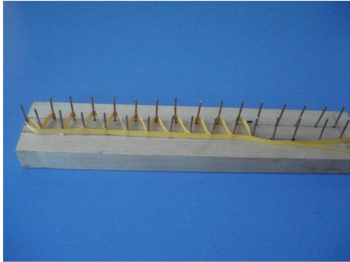
Тихонко снимаем с петельчатого инструмента.
