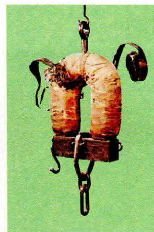
Электромагнит, изготовленный Генри, мог поднять груз массой 1 т.
