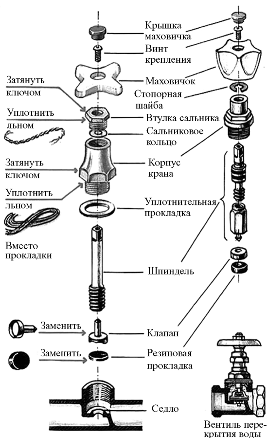
Рис. 61. Ремонт крана
