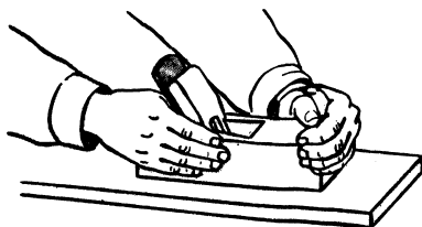
Рис. 9. Правильное положение рук при строгании рубанком
