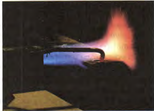
Рис. 131. Пламя водородной горелки
