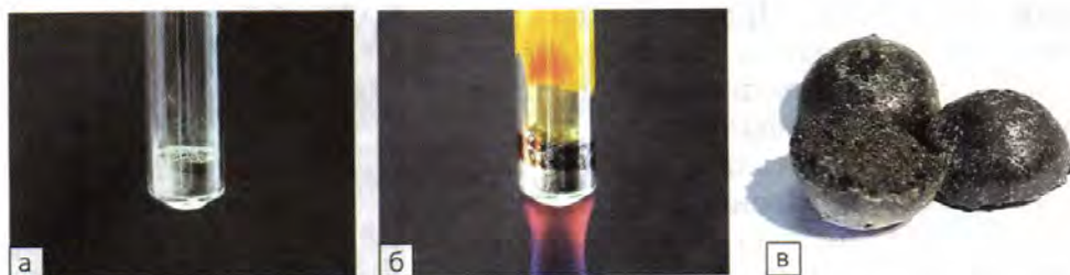
Рис. 96. При нагревании смеси железных опилок и серы (а) происходит химическая реакция (б), в результате которой образуется сульфид железа (в)
