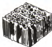
Рис. 85. Адсорбент — активированный уголь под микроскопом
