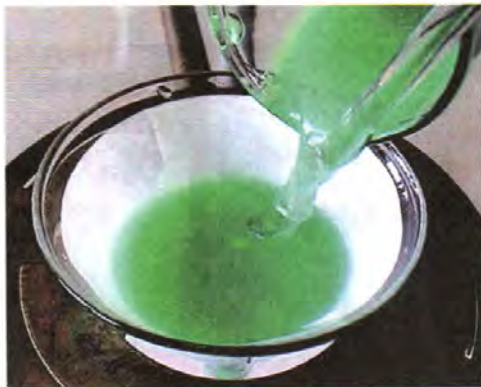
Рис. 83. Фильтрование жидкости с осадком через бумажный фильтр
