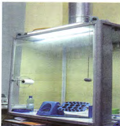
Рис. 27. Вытяжной шкаф в школьной лаборатории
