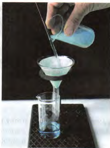
Рис. 95. Установка для фильтрования
