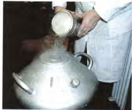
Рис. 91. Сжиженный азот хранят в специальных термосах
