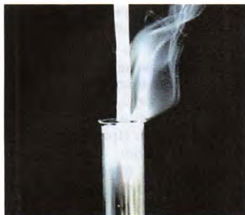
Рис. 66. В пробирке с углекислым газом горящая лучинка гаснет
