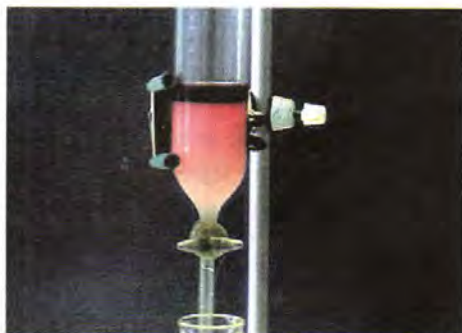
Рис. 80. Разделение двух несмешивающихся жидкостей с помощью делительной воронки
