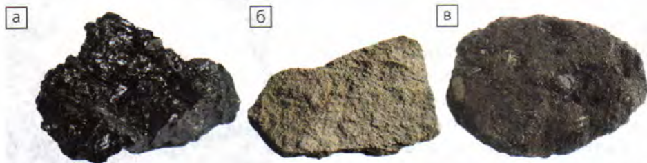
Рис. 56. Горючие осадочные породы органического происхождения: а — каменный уголь; б — торф; в — горючие сланцы
