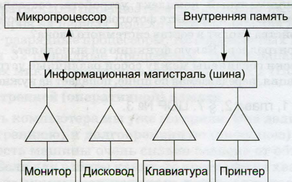
Рис. 2.9. Структура ПК (треугольниками изображены контроллеры)
