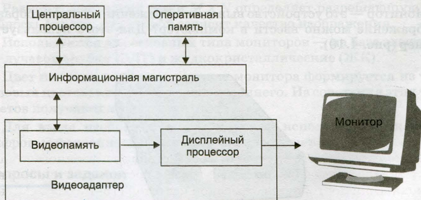
Рис. 4.9. Схема системы вывода изображения на экран
