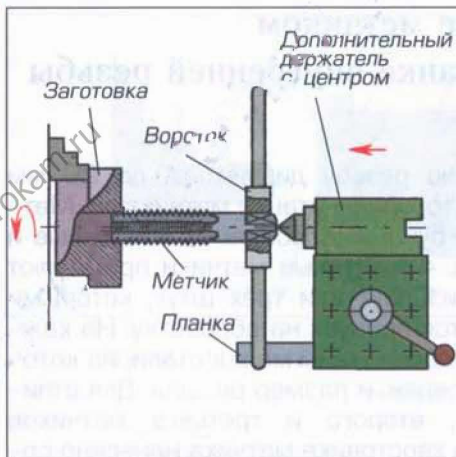
Рис. 44. Нарезание внутренней резьбы с использованием дополнительного держателя
