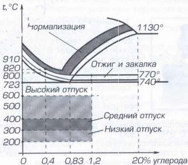
Рис. 32. Режимы нагрева стали при различных видах термической обработки
