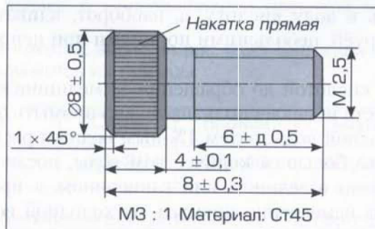
Рис. 109. Чертёж установочного винта
