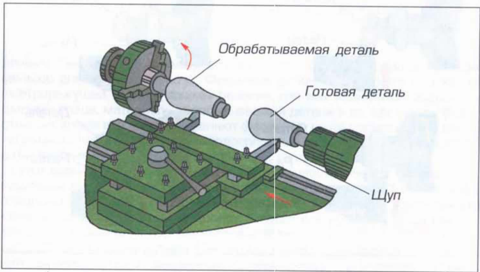
Рис. 86. Применение копира в виде готовой детали
