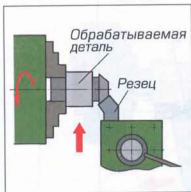
Рис. 71. Получение конусной поверхности на детали с помощью широкого резца
