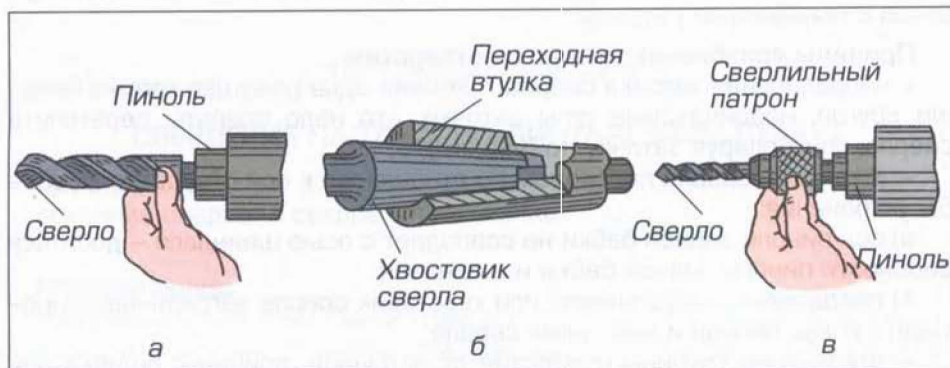
Рис. 48. Установка сверла непосредственно в пиноль (а), с помощью переходной втулки (б), с помощью сверлильного патрона (в)
