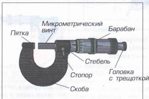
Рис. 51. Устройство микрометра
