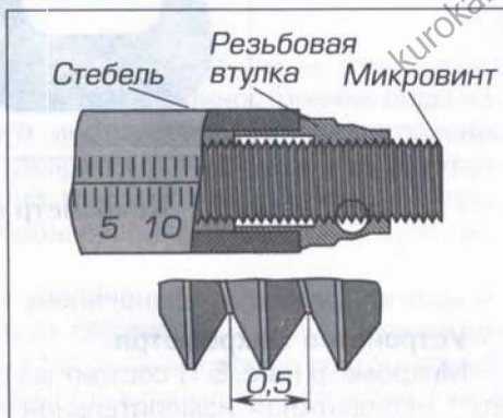
Рис. 53. Шаг микрометрического винта
