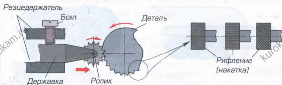
Рис. 108. Процесс рифления
